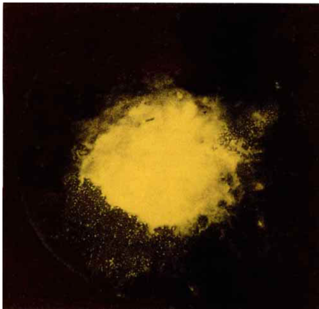
Abb. 1. Photographie der Lumineszenz von 1 , die durch Zugabe eines Tropfens Chloroform zu einer kristallinen Probe ausgelöst wurde, nachdem die Probe mit UV-Licht der Wellenlänge 366 nm bestrahlt worden war.
